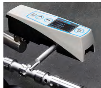
Taster um 90° schwenkbar
