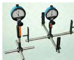
Kreuzhülse ab Ø 130 mm für Zentrieransätze oder Messung mit Tiefenanschlag
