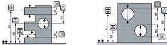
Messen mit Wechsel der Messrichtung
