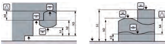
Messen ohne Wechsel der Messrichtung
