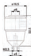
Axialer Messeinsatzhalter für Messeinsätze mit Gewinde M2,5
