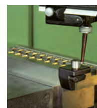
Beim Positionieren der Arbeitsspindelachse an der Werkzeugkante
